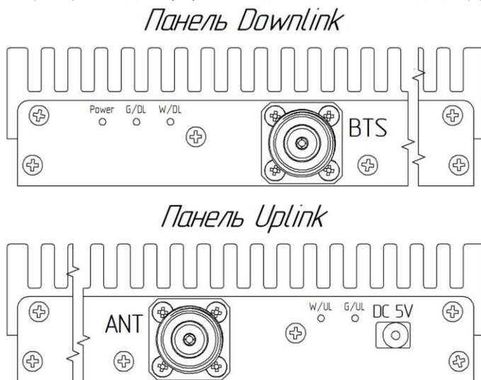
Рисунок 1 – Панели усилителя
